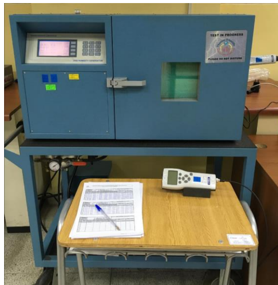
Figura 3. Montaje para la calibración del patrón viajero.
